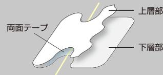
両面テープと上下のテープの接着によりチューブをしっかりと固定します。
